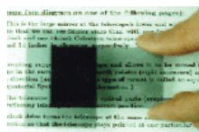
A Polarização é um fenômeno que acontece somente com as ondas transversais. Consiste na seleção de um plano de vibração frente aos outros por um objeto, ou seja, se incidir ondas com todos os planos de vibração num certo objeto, este acaba deixando passar apenas aquelas perturbações que ocorrem num determinado plano.
